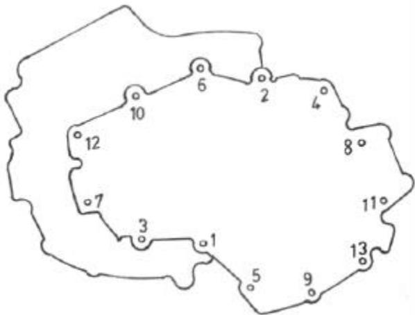
Bild G 29. Anzugsschema (20 + 2 Nm)
