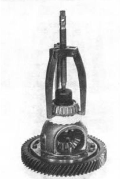
Bild G 26. Lagerinnenring des Kegelrollenlagers abziehen
