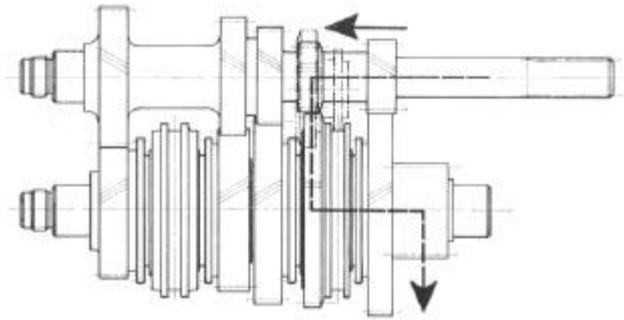
Bild G 6. Kraftverlauf für den Rückwärtsgang
