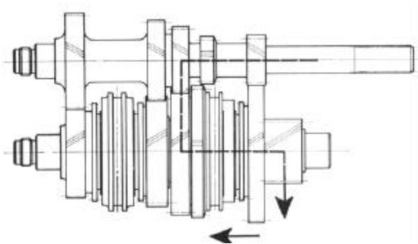
Bild G 3. Kraftverlauf für den 2. Gang
