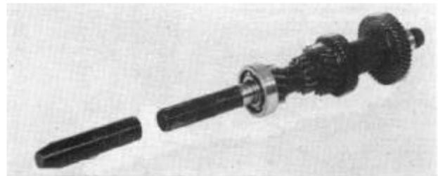
Bild G 27. Führungshülse für Radialwellendichtring
