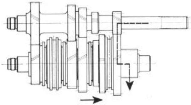
Bild G 2. Kraftverlauf für den 1. Gang
