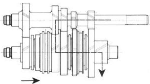
Bild G 4. Kraftverlauf für den 3. Gang
