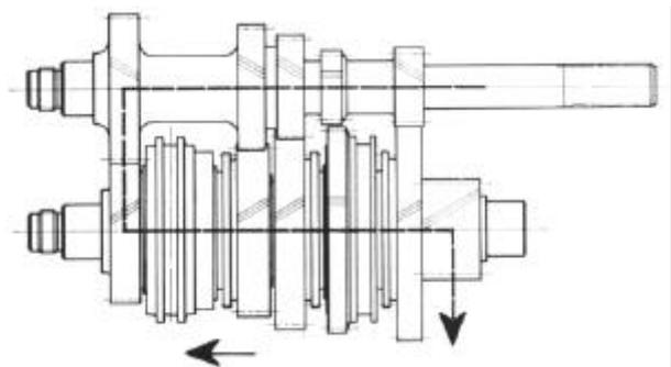
Bild G 5. Kraftverlauf für den 4. Gang
