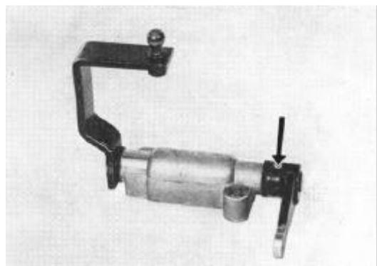
**Bild G 17. Kerbstift für Hebelwelle**
