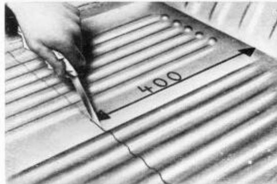
Bild 27. Lage der Trennlinie im Bodenblech
