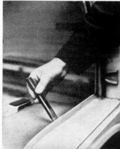
Bild 26. Trennung der Außenhaut vollst. unter der Fahrertür unmittelbar am Punktrand des Radkastens
