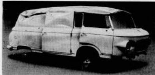
Bild 8. Stark beschädigtes Dach
