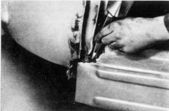
Bild 25. Trennung der A-Schweißverbindung Kastensäule Scharnierseite (Fahrertür) mit Außenhaut vollständig unter der Fahrertür und dem Halter für die Windlaufsäule
