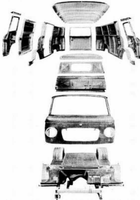
Bild 3. Darstellung der den Wagenkörper ergebenden Sektionen
