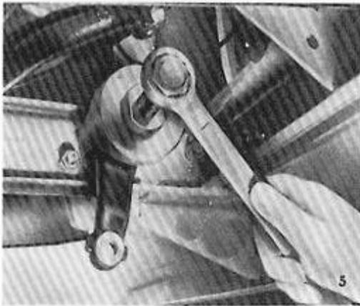
Nach dem Entsihern der Sechskantmutter am Lenstockhebel Sechskantmutter abschrauben und Lenstockhebel mit Abzieher für Lenstockhebel 04 09309 000 abziehen.
