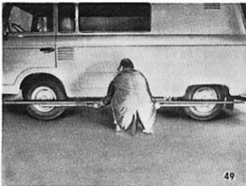
Ausrichten des Fahrzeuges in die Geradeausstellung.
