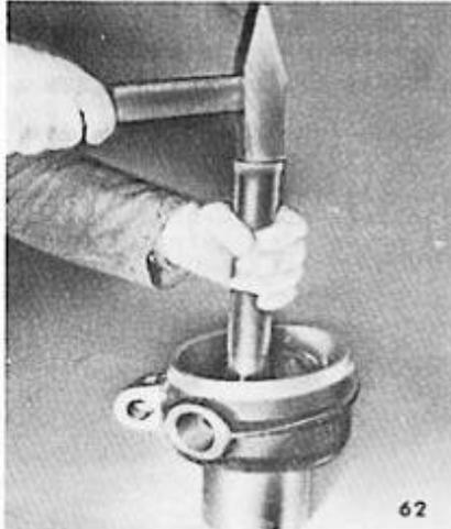
Die beiden Lageraußenringe der Kegelrollenlager 30208 werden aus dem Antriebsgelenkgehäuse mit einem Messingdorn herausgeschlagen.
