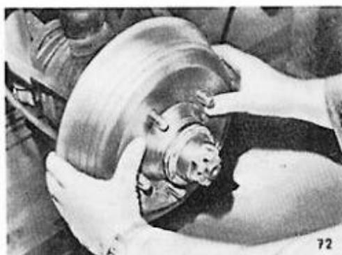
Durch Kippbewegungen der Bremstrommel kann die Lagerspieleinstellung überprüft werden.
