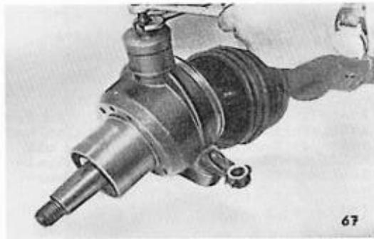
Mit dem Nadellagerauszieher kann anschließend das entsprechende Nadellager aus dem Antriebsgelenkgehäuse herausgezogen werden.
