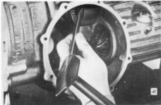
Die Spezialmutter ist mit Stemmwerkzeug - 19 90026 006 (V-10990) zweimal zu sichern, indem der Bund der Nutmutter in die Bohrungen der Freilaufnabe geschlagen wird. (Bild 41)
