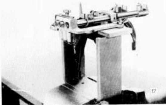
Kontermuttern M 6 von den Kegelschrauben des Schaltstangenmitnehmers, den Schaltstangen für den 1. und 2. Gang sowie des Rückwärtsganges lösen. Nach Herausschrauben der Kegelschrauben und Lösen der Klemmschrauben können die Schaltstangenmitnehmer und die Schaltgabeln für den 3. und 4. Gang abgezogen werden. Schaltstangen nacheinander herausdrücken.
