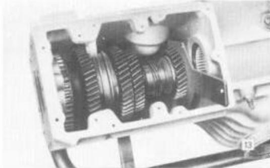
Gabel - 19 90020 000 (V-10118) zwischen Abtriebsrad 4. Gang und Getriebegehäuse einschieben und Ritzelwelle in Richtung Achsgehäuse durchschlagen.
