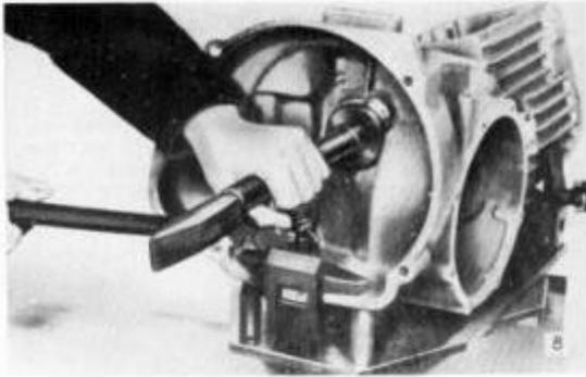
Schlagdorn - 19 90016 004 (V-9788) in die Nadellagerbohrung der Hauptwelle einführen und Welle durch leichte Schläge herausschlagen, bis sich die Nabe löst und der äußere Lagering des Lagers Q 305 aus der Gehäusebohrung herausfällt.
