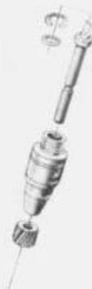
Ist es erforderlich, das Tachoritzel bzw. die Tachowelle auszuwechseln, so ist mit einer Handhebelpresse die Tachowelle mit einem Dorn nach der Mitnehmerseite herauszudrücken. Bei Montage ist die Tachoantriebswelle mit einer Hülse am Bund zu unterstützen. Das Tachoritzel ist mit der angefasten Seite der Bohrung auf den Zapfen der Tachoantriebswelle aufzudrücken. (Einzelteile siehe Bild 28)
