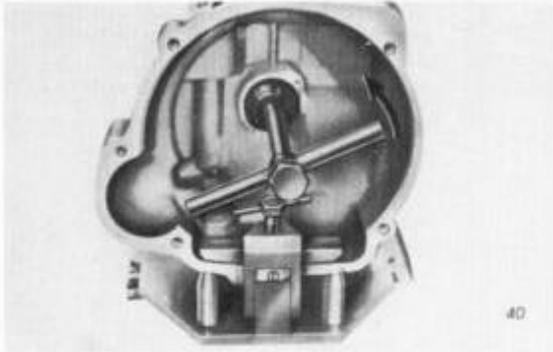
Von vorn Freilaufnabe aufstecken und Spezialmutter aufschrauben (Linksgewinde). Spezialmutter mit Steckschlüssel - 19 90038 001 (V-13190) festziehen. **(Anzugsdrehmoment beachten!)** (Bild 40)
