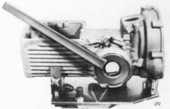
Beim Auswechseln des Kegelrollenlagers 30213 ist mit dem Zapfenschlüssel - 19 90017 005 (V-8312) der Einstellring an der Lagerbuchse herauszuschrauben.
