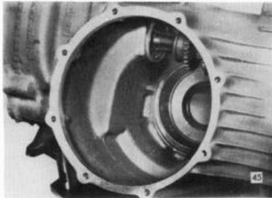
Die Montage der Antriebswelle hat nunmehr so zu erfolgen, daß das Loch Ø 3 mm des Ölspritzbleches unten liegt.
