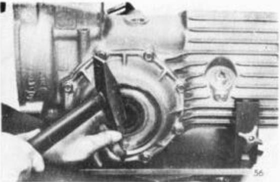
Einstellringe beidseitig durch Einschlagen des Bundes in die dafür vorgesehene Aussparung der Lagerhülse bzw. Differentialdeckels sichern.
