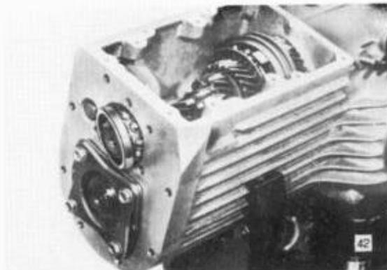
Zweite Hälfte des Lageraußenringes vom Schrägkugellager Q 305 mit der Einschlagvorrichtung für Lager Q 305 19 90019 007 (V-9789) einschlagen. (Bild 42)
