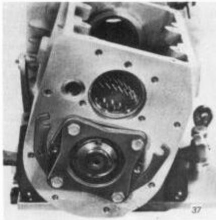
Stimmt das ausgeblockte Maß **nicht** mit dem auf der Ritzelwelle eingezeichneten und vorher notiertem Einstellmaß überein, so muß am Lagerträger die Differenz durch Beilegen von Ausgleichshälften ausgeglichen werden.
