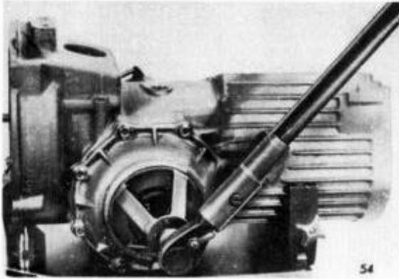
Ist die Einstellung des Zahnflankenspiels erfolgt, so sind die Einstellringe beidseitig mit einem Drehmomentenschlüssel unter Verwendung des Schlüssels - 19 90039 002 (V-10226) festzuziehen.
