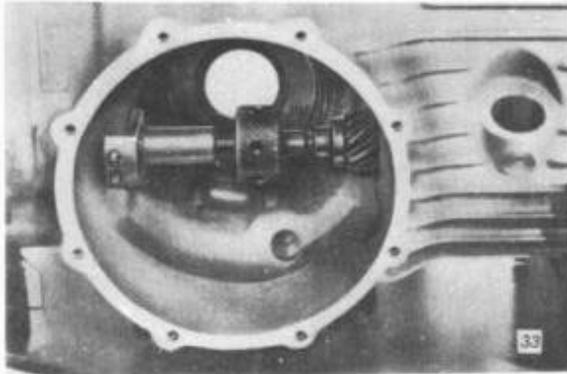
Die Ritzelwelle wird dann im Achsgehäuse mit der Unterstützungsspindel 19 90035 007 (V-10260) festgelegt.
