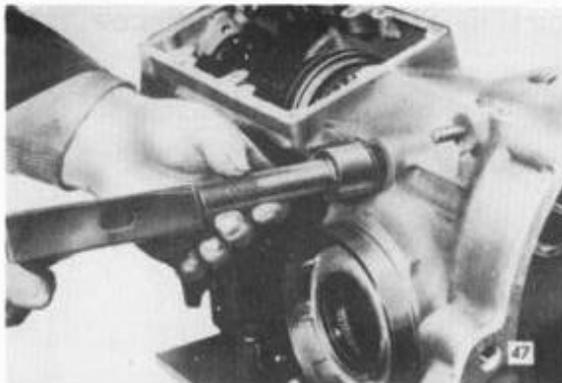
Schaltschwingerstein in Schaltschwinge für Freilaufsperrung einsetzen. Führungsbuchse mit kompletter Schaltschwinge mit Einschlagdorn vorsichtig einschlagen.
