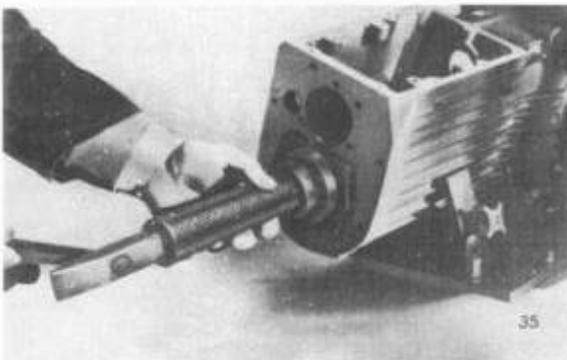
Der Lagerträger mit eingepreßtem Lageraußenring wird mit der Montagevorrichtung - 19 90036 008 (V-11721) eingeschlagen sowie der zweite Lagerinnenring auf die Ritzelwelle aufgeschlagen.
