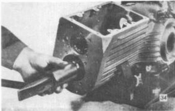
Mit einer geeigneten Schlagbuchse wird danach zuerst die eine Hälfte des Lagerinnenringes des Schrägkugellagers 3306 D auf die Ritzelwelle geschlagen.
