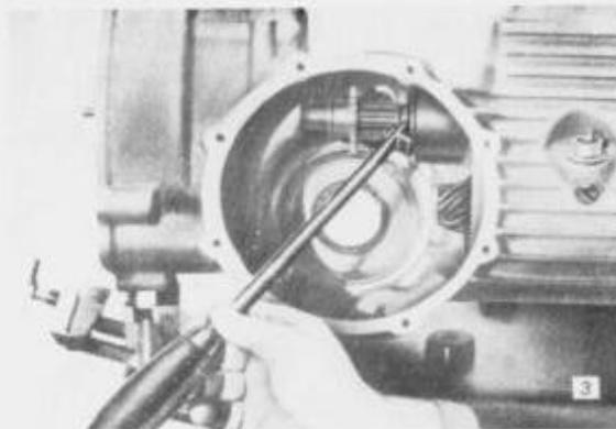
Abdrückhebel - 19 90025 005 (V-12121) in Nut auf Antriebswelle setzen und gegen Freilaufnabe hebeln, Antriebswelle mit Antriebs-lagerbuchse herausdrücken. (Bild 3)
