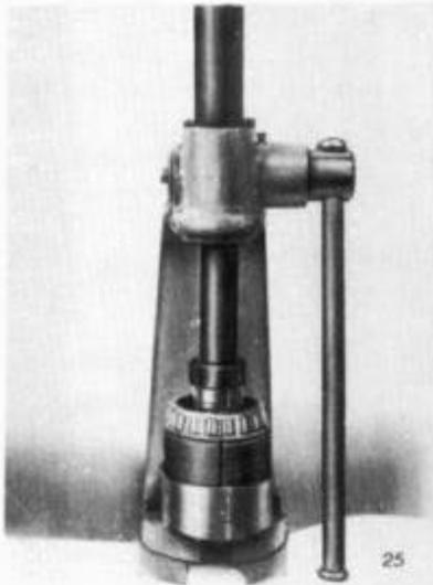
Die Innenringe der Kegelrollenlager 30213 mit Demontagevorrichtung - 19 90032 004 von den Lagerhülsen abdrücken.
