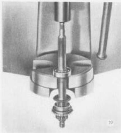
Sprengring 20x2 für Rillenkugellager von der Antriebswelle abnehmen und Lager abdrücken. (Bild 19)
