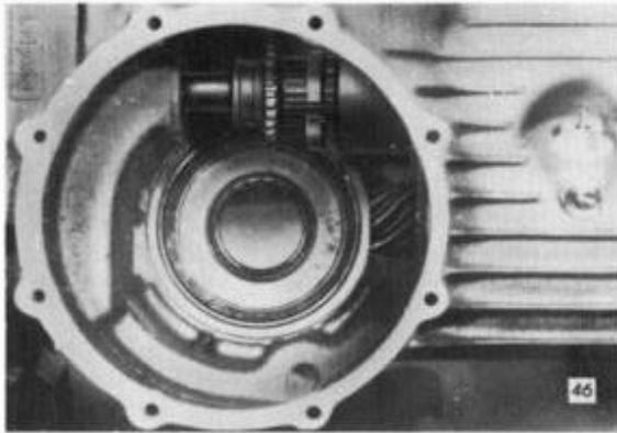
Beim Einschlagen der Antriebswelle schiebt sich der Haltering von den Zylinderrollen. Haltering muß unbedingt herausgenommen werden.
