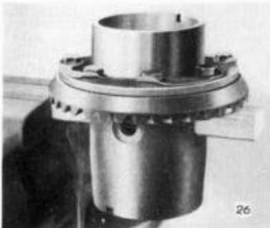
Muß das Tellerrad abgeschraubt werden, ist das Ausgleichgehäuse auf eine in den Schraubstock eingespannte Leiste zu stecken.
