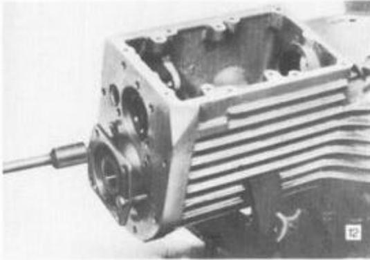
Nach dem Abschrauben der 4 Sechskantschrauben M 8x30 am Lagerträger, ist der Lagerdeckel abzunehmen. Der Lagerträger wird mit 2 Sechskantschrauben M 8x45 gegen das Getriebegehäuse abgespindelt.
